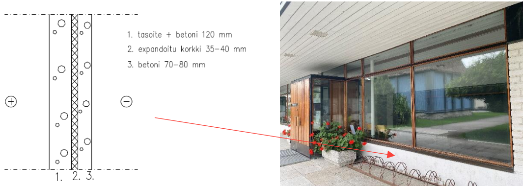
Kuva 22. Sokkelirakenne rakennuksen pohjoispuolella
